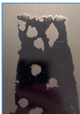
Fig. 1B PUD transparent coating without substrate wetting agent within 0,5% of SILTOP 715; applied on PVC foil Rivestimento PUD trasparente con lo 0,5% di Siltop 715, applicato su foglio PVC
